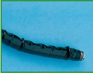
Aufquellung am Distalende eines Fiberskops
