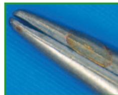
Säureangriff der Lotnähte und Hartmetalleinlagen mit starker Abnutzung derselben als Folgeschaden.
