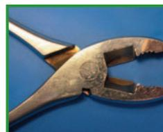
Verchromte Kombinationszange aus dem Baumarkt. Nicht verchromte Bereiche (z.B. Gelenk) führen zu Korrosionsbelägen. --> Gefahr von Fremdstoffübertragung auf NR-Instrumente.
