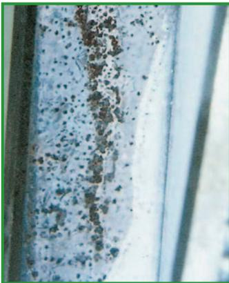
Ablagerungen eines chloridhaltigen Ätzmittels auf einem Instrument
