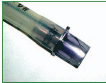
Die Spannungsrisskorrosion, z. B. bei Polysulfon, führt zu sichtbaren Rissen bzw. Brüchen.
