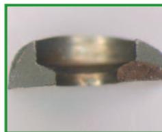
Bruchfläche in der Bohrungssenkung für Schraubenkopf
