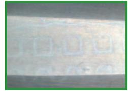
Instrumentenoberfläche mit Perforationsabbildung von Siebkorb
